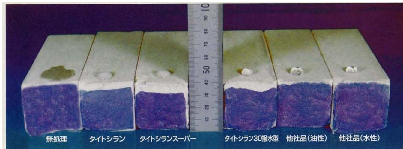
在供試體上面，塗布各材料後進行割斷，割斷面以水性墨水染色。
